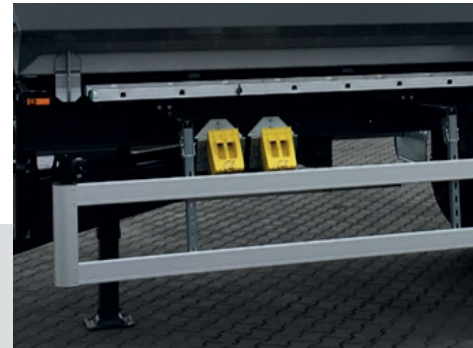
Pare-cycliste (en option) placé en amont de l'essieu pour limiter les dommages en cas de contact avec des tiers.
