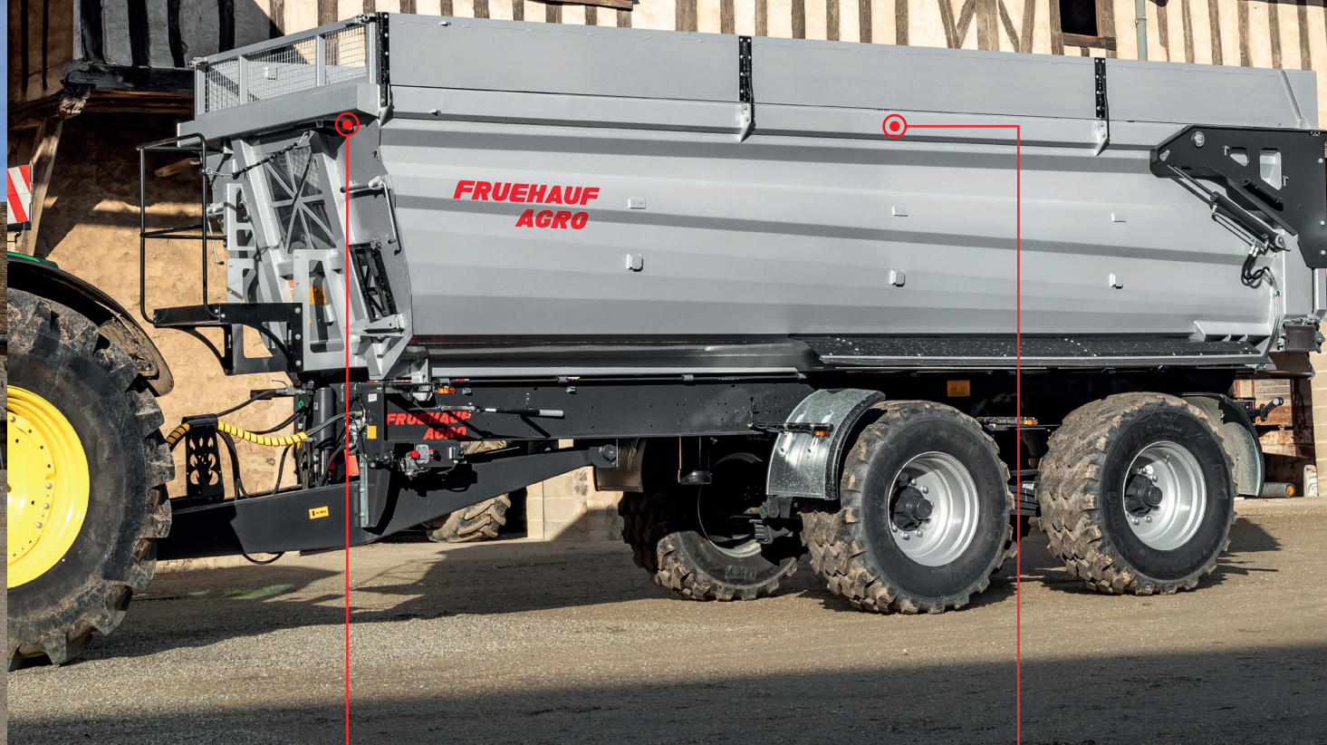
Face avant inclinée avec hublot de vision de 720 x 608 mm avec plate forme de travail (en option)
