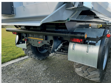
Barre anti-encastrément en position approche
